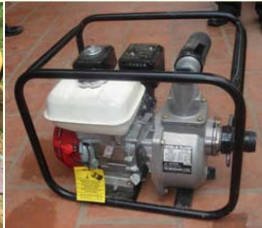
Máy bơm chạy bằng xăng đắt hơn More expensive gasoline pump
